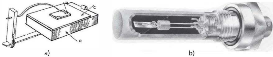
Figure 17.6 – Hygromètre à diélectrique en \text{Al}_2\text{O}_3 : a) cellule Panametrics ; b) vue en coupe d'un capteur.
