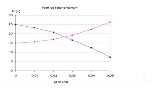
L'intersection entre les deux courbes défini le point de fonctionnement A :  $Q \approx 0.026 \text{ m}^3/\text{s} = 26 \text{ Us et H} \approx 18.5 \text{ m}$ .
