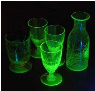
Verres sous une lampe à UV, montrant la fluorescence caractéristique causée par la présence de dioxyde d'uranium.
