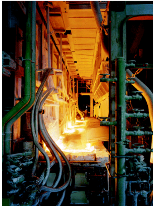
L'enfourneuse alimente le four de fusion dont la température atteint 1650 °C.
