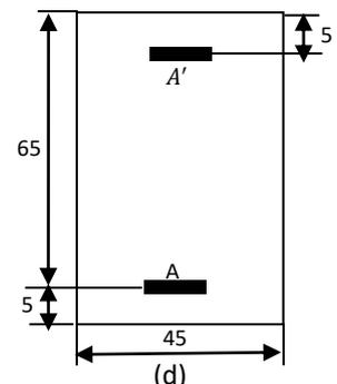
Comme  $N(d-c)-M_1 > (0.337-0.81\frac{c'}{h}) b.h^2 \bar{\sigma}_b \Rightarrow$  la section est entièrement comprimée.
