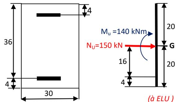
Le centre de pression se trouve en dehors de la zone limitée par les armatures, donc la section est partiellement comprimée.
