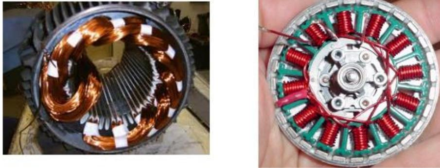
Figure IV.10. Bobinages de différents moteurs
