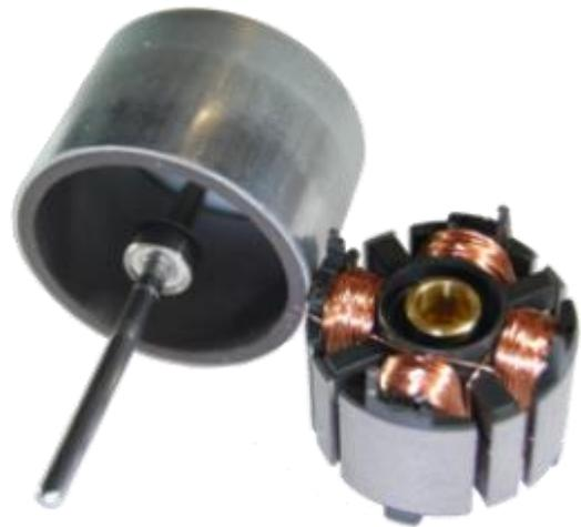
**Figure IV.4.**Rotor et stator d'un moteur brushless outrunner
