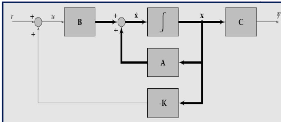
Figure 2: Représentation d'un système en espace d'état avec retour d'état
