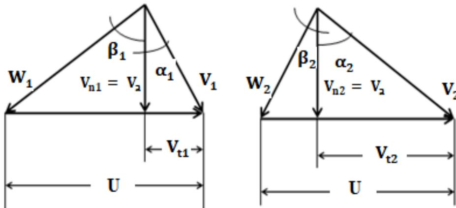
Figure 1. Triangle de vitesses d'entrée et de sortie du rotor d'un étage
