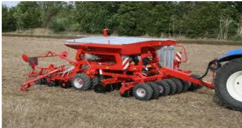
Figure () : combinaison de plusieurs outils dans une seule machine de semis des céréales.
