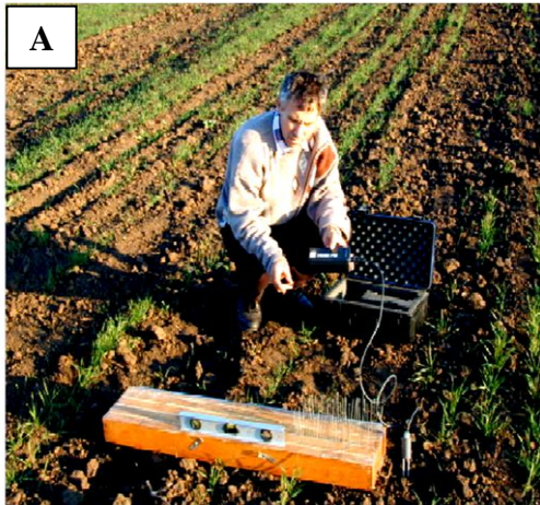
Photo 07: Le rugosimètre à aiguille A (Zaher, 2010), B (Nord 2006).
