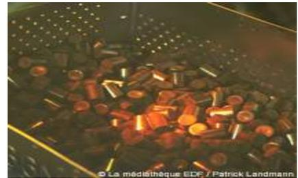
Les pastilles sont enfilées dans des **tubes en métal** de 4 m de long dont les extrémités sont bouchées, pour constituer ce que l'on appelle des **crayons**. Ces **crayons** sont regroupés par lots dans des **assemblages combustibles** (figure 15). Ces assemblages sont placés dans le cœur du réacteur pour le faire fonctionner.
