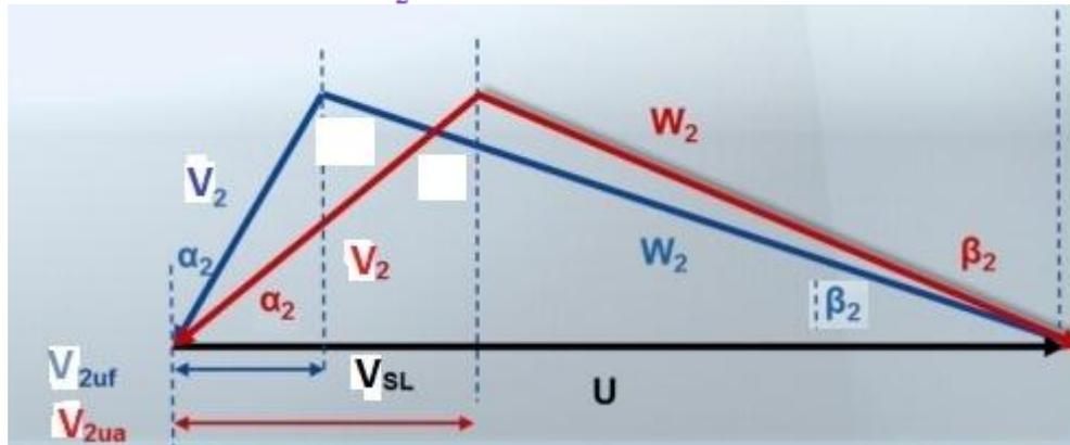
Figure –( 2.10b), triangle de vitesse avec déviation
