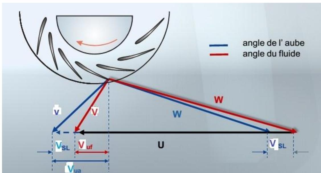
Figure -( 2.10a), aubes et triangle de vitesse avec déviation
