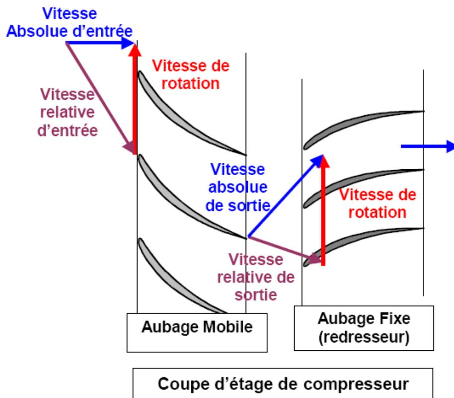
Écoulement de l'air dans les aubes mobiles :
