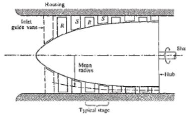
Figure (3-2), compresseur axial
