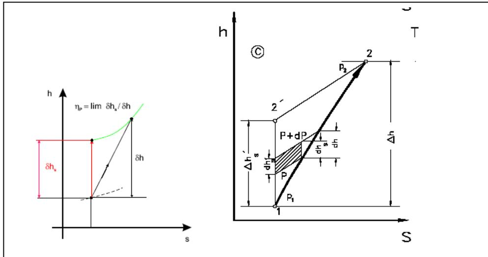
Figure-(3-5), diagramme ( H,S) d'un étage
