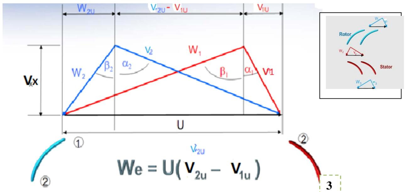
Soit la vitesse d'entraînement  $U_1 = R_1 \cdot \omega$ ,  $U_2 = R_2 \cdot \omega$ , avec  $U_1 = U_2 = U$
