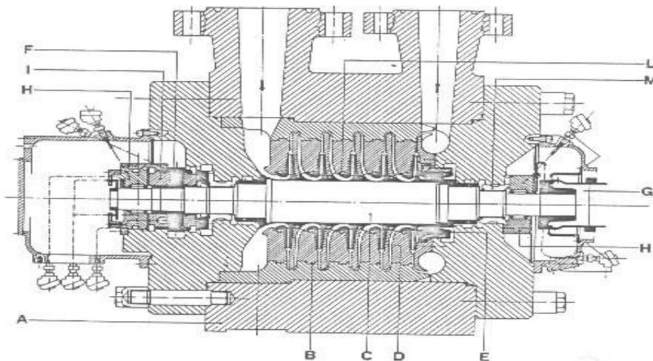
**Fig2.2: Compresseur centrifuge**
