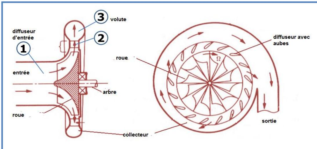
Leur rôle est de transformer l'énergie cinétique en énergie de pression statique dans le stator, les rotors permettent d'augmenter l'énergie cinétique et la pression statique en même temps.
