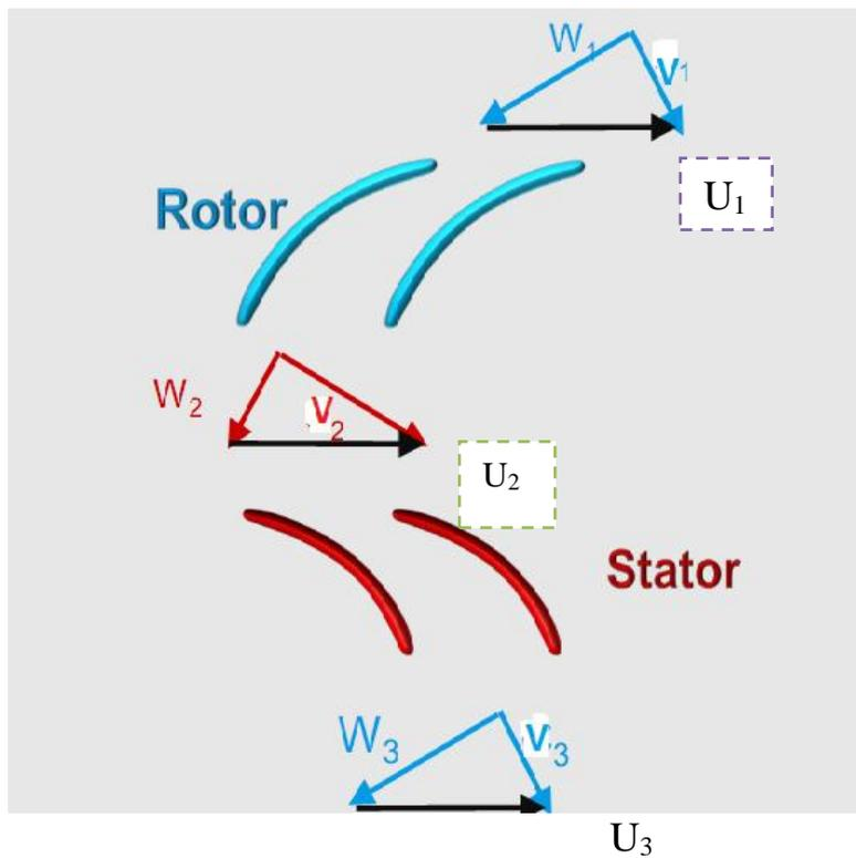
Figure –(3-3), triangle de vitesses dans un étage
