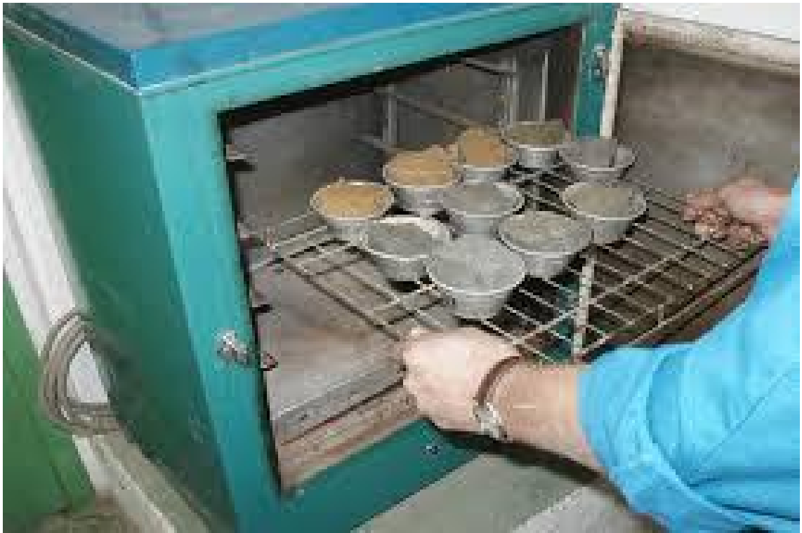
Séchage des granulats.
