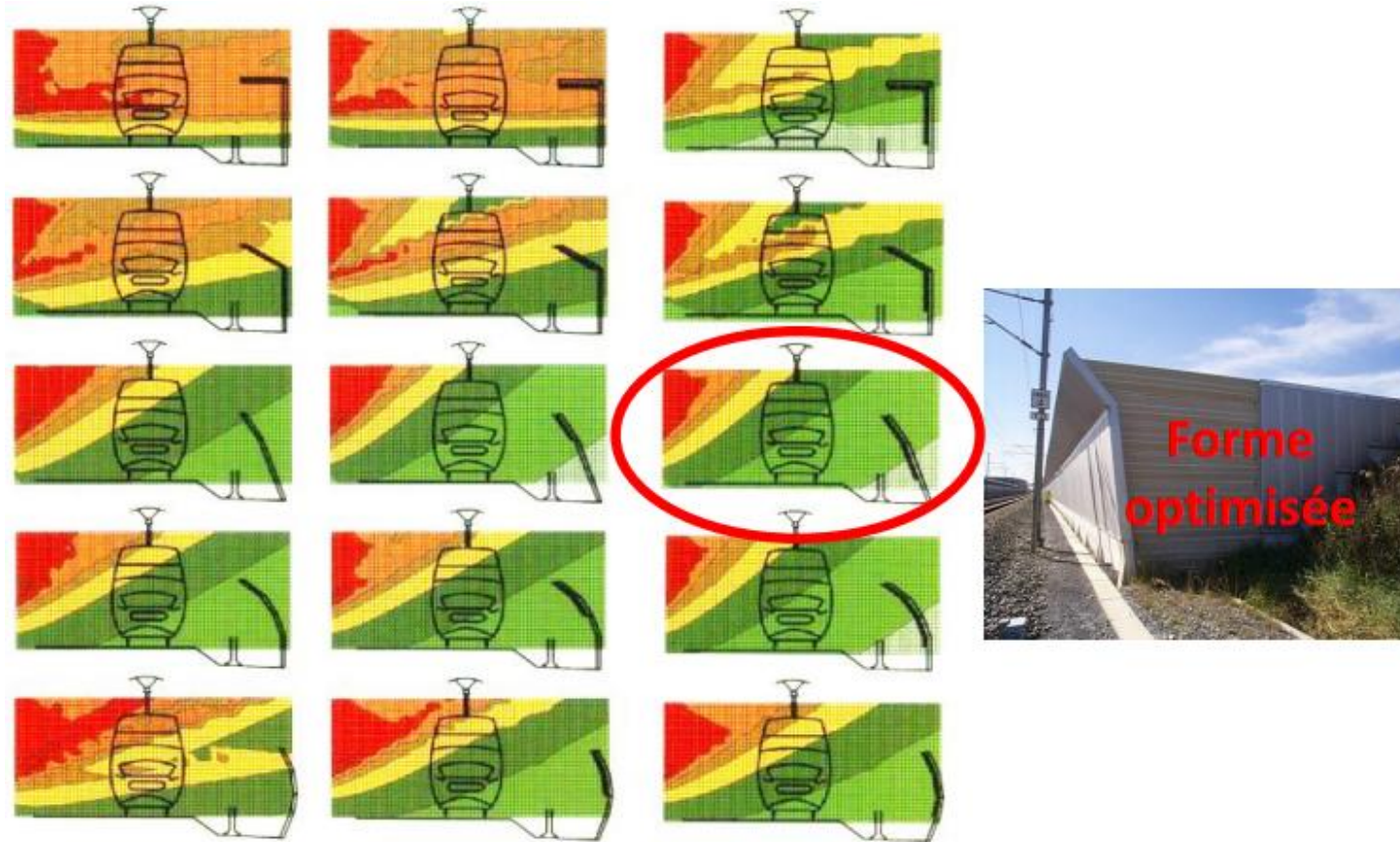
Figure 46 – Cartes de bruit (de -15 m à +45 m au-dessus du rail, et de 10 à 150 m à droite du rail) en fonction du type d'écran pour le TGV (forme et caractéristiques d'absorption acoustique)
