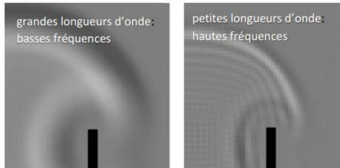
Figure 44 – L'importance de la longueur d'onde sur la performance d'un écran
