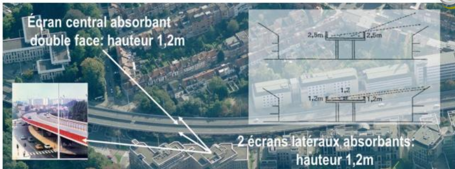
Figure 40 – Utilisation d'un écran «central» afin de réduire la hauteur d'écrans «latéraux»
