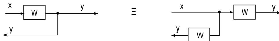
**Exemple 4.3.3** En utilisant les règles précédentes de disposition des éléments. On peut reproduire un schéma fonctionnel à contour multiple en un schéma à contour simple.
