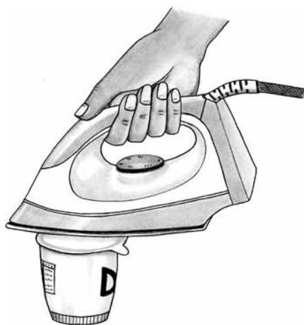
Figure 34 : Scellage des couvercles en aluminium avec un fer à repasser
