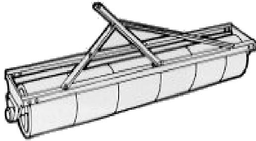
**2. Rouleau ondulé :** sa structure et son poids sont analogues au rouleau lisse. La différence réside dans l'utilisation de tôle fortement nervurée. Cette conception fragilise la croûte formée et la rend plus facile à traverser par les plantes qui lèvent.
