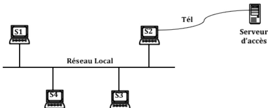
Les stations  $S_1$ ,  $S_2$ ,  $S_3$ ,  $S_4$  sont reliées par un réseau local en bus offrant un débit de 10 Mbits/s. La station  $S_2$  est reliée à un serveur d'accès internet par une liaison téléphonique dont la bande de fréquence est de [300-3400 Hz].
