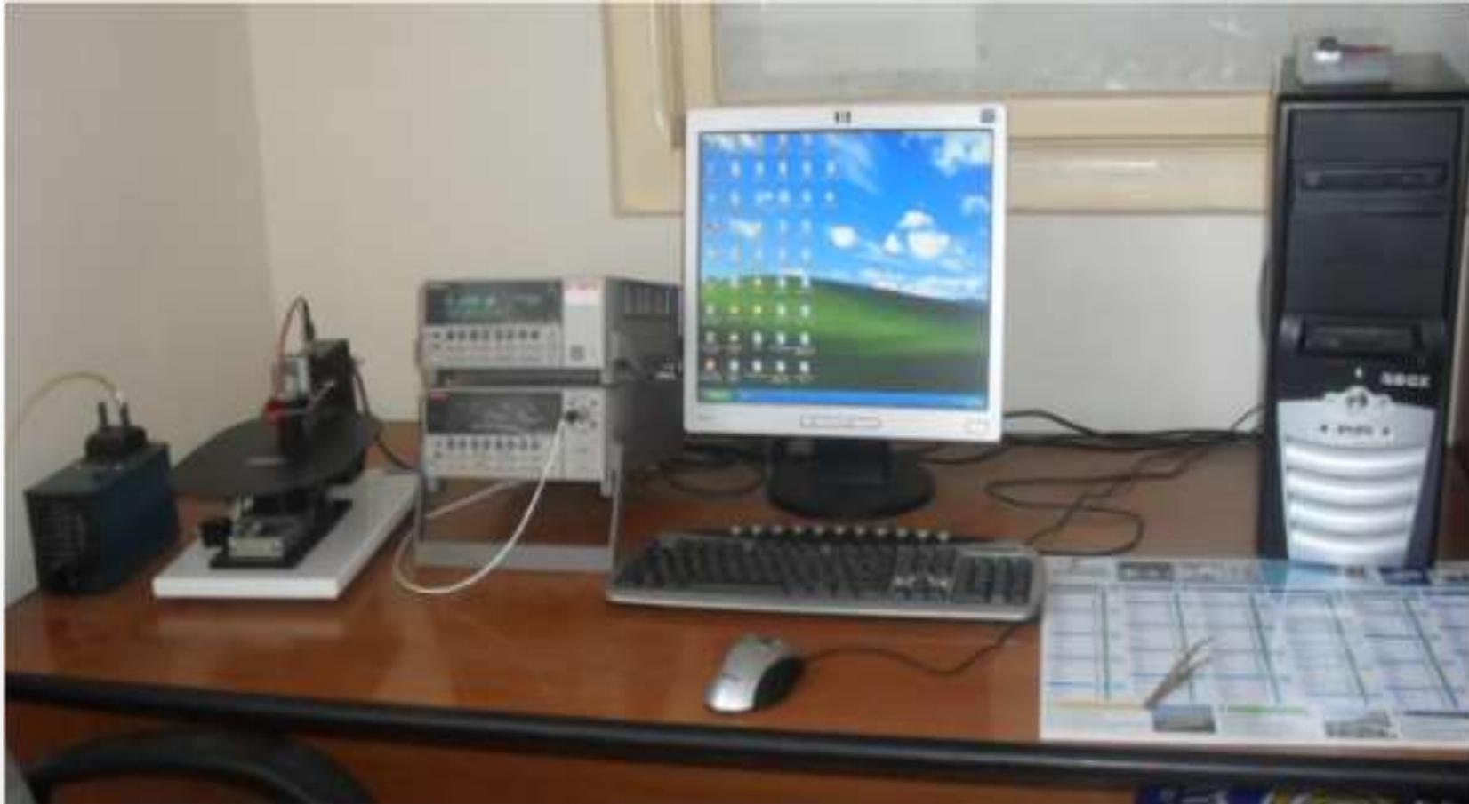
*Banc de mesure de la résistivité électrique*
