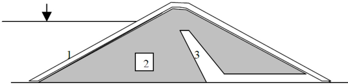
1 : protection                      2 : corps de digue                      3 : drain et tapis
