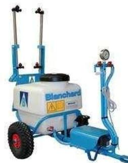
La hauteur de la rampe doit permettre aux jets de se chevaucher (ex. 30% de la surface traitée pour les buses qui ont un angle d'ouverture de 80°)
