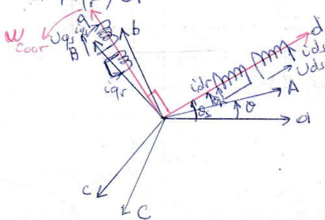
$\theta$ : position angulaire du rotor par rapport au stator.
