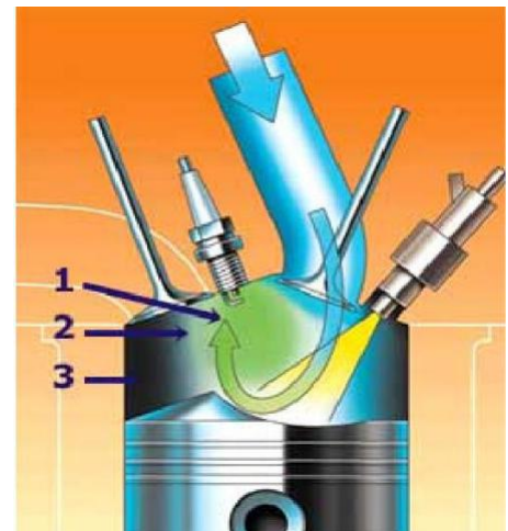
Figure 2.22. Propagation de la combustion dans le cas d'une charge stratifiée
