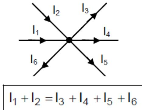
Si on affecte du signe + l'intensité d'un courant qui traverse se dirige vers un nœud, du signe -l'intensité d'un courant qui s'en éloigne, nous pourrions dire que : en un nœud de courant, la somme algébrique des courants est nulle,
