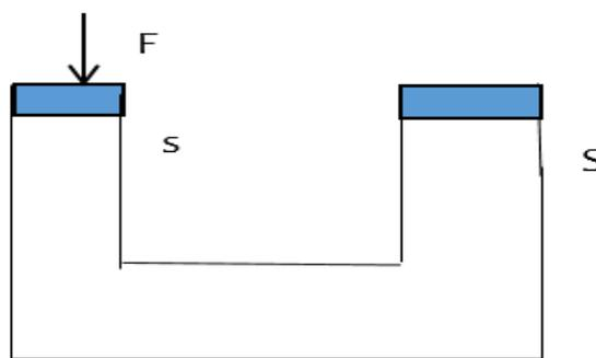
Figure 6.3 : Presse hydraulique
