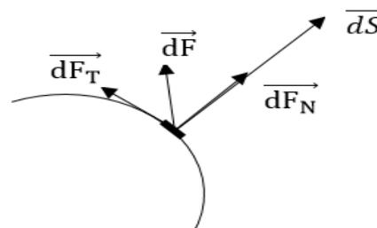
Figure 6.1 : Forces exercées par le fluide
