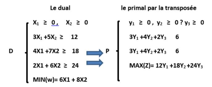
On applique le simplexe normal sur la transposée P. une fois la solution optimale atteinte, il faut lire les résultats à partir du vecteur hors base de P (autrement dit verticale).
