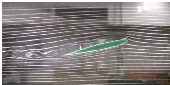
Ligne de courant des fumées
