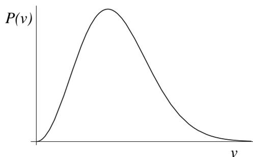
Figure 7.9. La distribution statistique des vitesses des molécules dans un gaz parfait, selon Maxwell.
