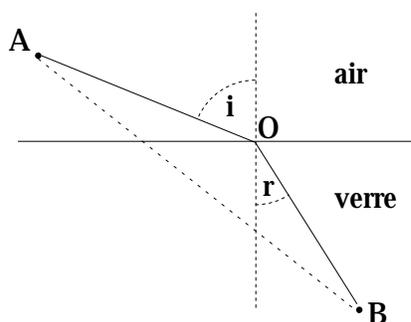
Figure 6.2. Schéma de la réfraction d'un rayon lumineux à une interface, par exemple entre l'air et le verre.
