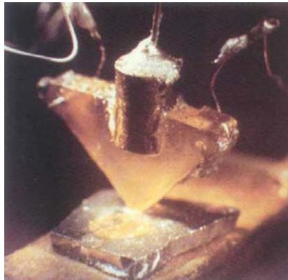
Figure 13.3. Le tout premier transistor, dit *transistor à contact ponctuel*, fabriqué en décembre 1947.
