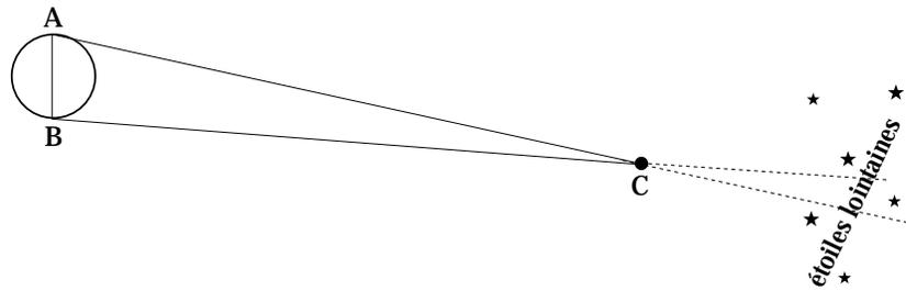
Figure 10.1. Schéma illustrant la méthode de la parallaxe. On mesure la position angulaire de l'objet C, c'est-à-dire les angles  $\alpha$  et  $\beta$  (ou  $\alpha$  et  $\gamma$ ), à partir de deux points A et B. Connaissant la distance AB, on en tire la distance de l'objet (AC ou BC). Cette méthode suppose bien sûr la présence d'étoiles très éloignées qui servent de toile de fond et permettent de mesurer l'angle  $\gamma$  comme déplacement apparent de l'objet C sur la voûte céleste.
