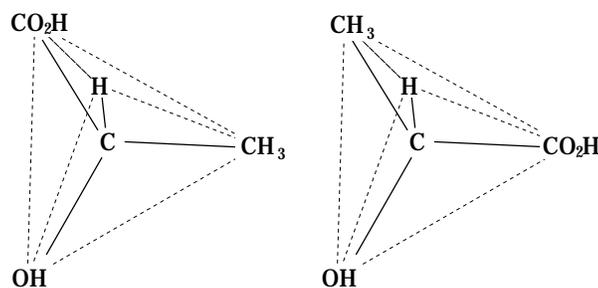
Figure 8.2. Deux molécules énantiomères, à structure tétraédrale, avec un atome de carbone au centre. La molécule de droite est obtenue par réflexion de celle de gauche, par rapport au plan passant par le carbone et par les radicaux H et OH. Par contre, elle n'est pas équivalente à une rotation de celle de gauche.
