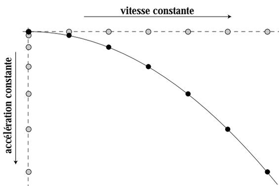
Figure 5.9. Mouvement parabolique comme composition d'un mouvement horizontal uniforme et d'un mouvement vertical uniformément accéléré.
