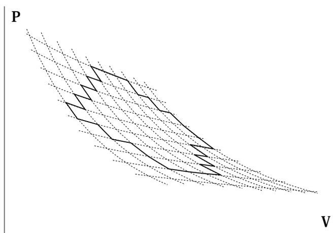
Figure 7.8. Tout cycle dans un diagramme de Clapeyron peut être décomposé en une somme de cycles de Carnot infinitésimaux. Sur ce diagramme, chaque losange constitue un petit cycle de Carnot et le cycle indiqué en trait gras en englobe un certain nombre. Le travail effectué au cours de ce cycle est la somme des travaux effectués lors de chacun des cycles de Carnot englobés. Dans la limite où la taille des cycles de Carnot tend vers zéro, tout cycle peut être représenté de cette façon.
