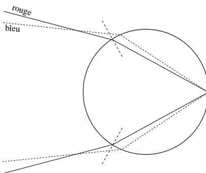
Figure 6.1. Schéma de la réfraction et réflexion de la lumière dans une gouttelette, expliquant le phénomène de l'arc-en-ciel. Le rayon rouge sortant de la goutte fait un angle de  $42^\circ$  avec le rayon entrant. Le rayon bleu est plus réfracté, mais l'écart angulaire entre les rayons bleus entrant et sortant est moindre, de sorte que le bleu apparaît vers le centre de l'arc et le rouge vers l'extérieur.
