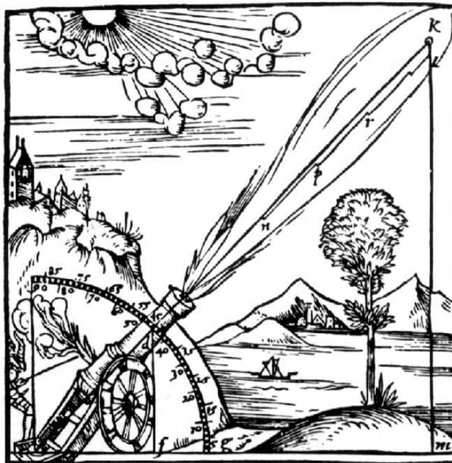
Figure 5.8. Pendant la Renaissance, on croyait, à l'instar d'Aristote, que le mouvement d'un projectile était constitué de deux phases : la première étant une trajectoire rectiligne (mouvement violent) et la deuxième une chute verticale (mouvement naturel). Galilée prétend au contraire qu'en l'absence de résistance de l'air, la trajectoire doit être parabolique.
