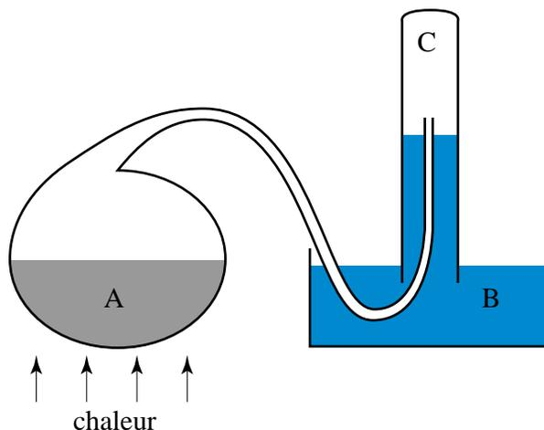
Figure 8.1. Schéma de l'appareil utilisé par Lavoisier dans ses expériences sur la combustion. Le ballon (A) contient le produit chauffé (Hg ou HgO selon le cas, avec ou sans charbon) et les gaz produits sont recueillis en C et leur volume peut être mesuré.
