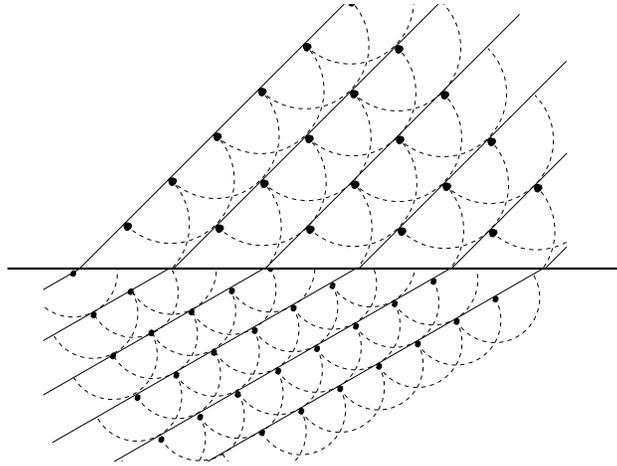
Figure 6.3. Illustration du principe de Huygens expliquant la propagation rectiligne d'une onde et sa réfraction.
