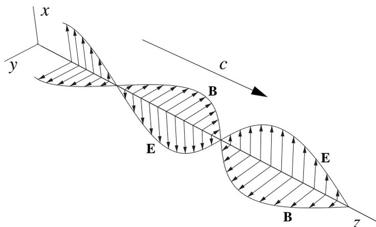
Figure 6.5. Configuration des champs électrique et magnétique dans une onde électromagnétique monochromatique à polarisation linéaire.
