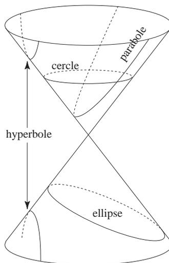
Figure 3.5. Définition des sections coniques comme intersections de différents plans avec un cône. Si le plan est perpendiculaire à l'axe du cône, on obtient un cercle. S'il est incliné, mais à un angle inférieur à celui de cône, on obtient une ellipse. S'il est incliné à un angle égal à celui du cône, on obtient une parabole. Enfin, s'il est incliné à un angle supérieur, on obtient une hyperbole.
