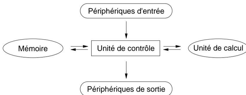
Figure 13.2. Schéma illustrant l'architecture proposée par von Neumann, encore employée de nos jours dans la vaste majorité des ordinateurs.
