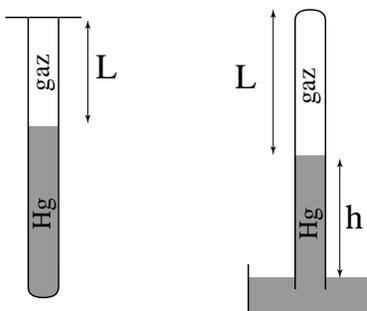
Figure 7.1. Schéma de l’expérience de Mariotte. À gauche, un tube est partiellement rempli de mercure et il reste une hauteur  $L$  d’air à l’intérieur. À droite, le même tube est retourné dans un bassin de mercure et la hauteur de la colonne d’air est passée de  $L$  à  $L'$ , alors que celle de la colonne de mercure est  $h'$ .
