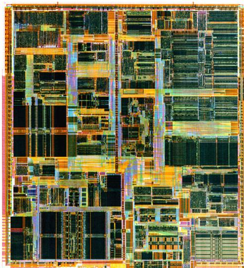
Figure 13.4. Le Pentium II, finalisé en 1997, contient environ 7,5 millions de transistors.
