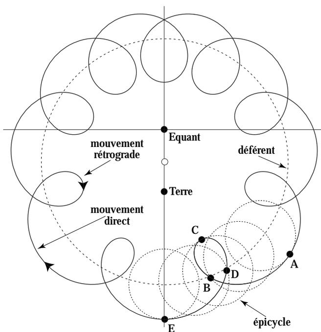
Figure 3.8. Schéma démontrant comment l'utilisation d'épicycles peut représenter le mouvement rétrograde d'une planète par rapport à la Terre. Les points A à E représentent des points équidistants sur l'épicycle (séparés par des intervalles de temps égaux, en l'absence d'équant) mais non équidistants sur l'orbite observée. On indique aussi l'équant, point par rapport auquel le déplacement du centre de l'épicycle est uniforme. La Terre n'est pas au centre du déférent, mais lui est excentrique.
