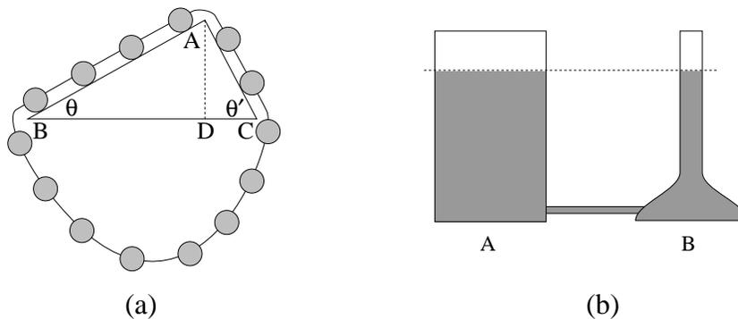
Figure 5.7. (a) Schéma utilisé par Stevin pour expliquer les composantes d'une force. (b) Schéma illustrant le principe des vases communicants.
