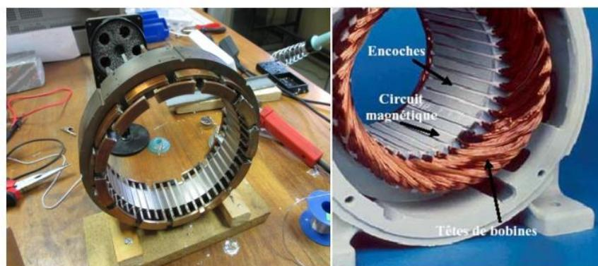
Figure I.12. Exemple de stator d'une MAS
