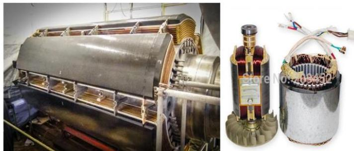
Figure I.7. Exemple de rotor bobiné à pôles saillants
