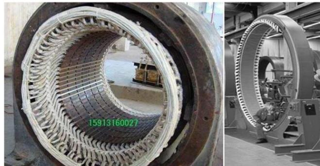
Figure I.5. Exemples de stator de machines synchrones en cours de fabrication
