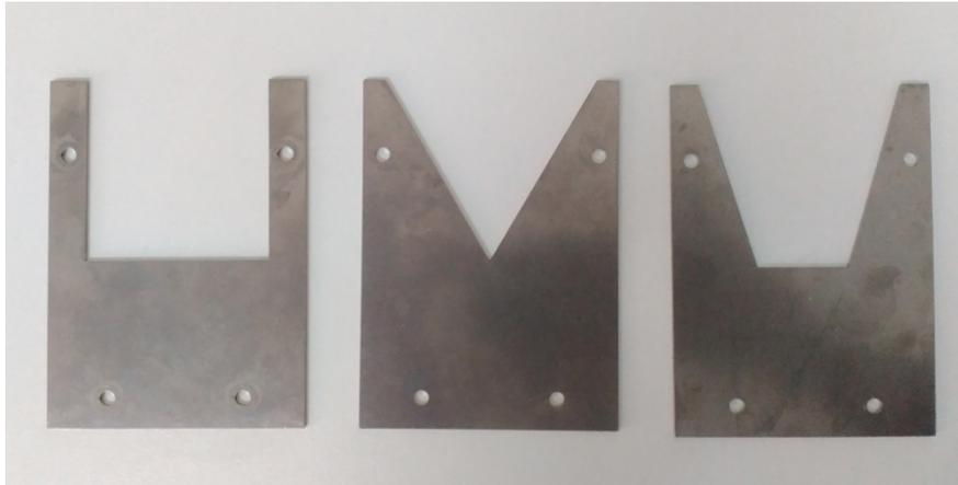
**Fig.IV.1.5** : Les trois déversoirs qui se montent sur le support sur fig.IV.1.1.
