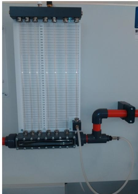
**Fig.III.2.4** : matériels utilisés (Venturi) pour la vérification de l'équation de Bernoulli
