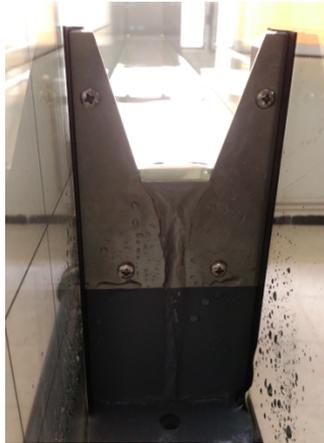
**Fig IV.1.1** : Un déversoir trapézoïdal
