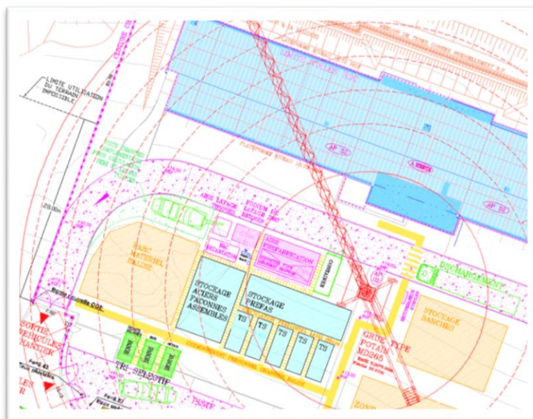
Fig.1 Plan d'installation de chantier
