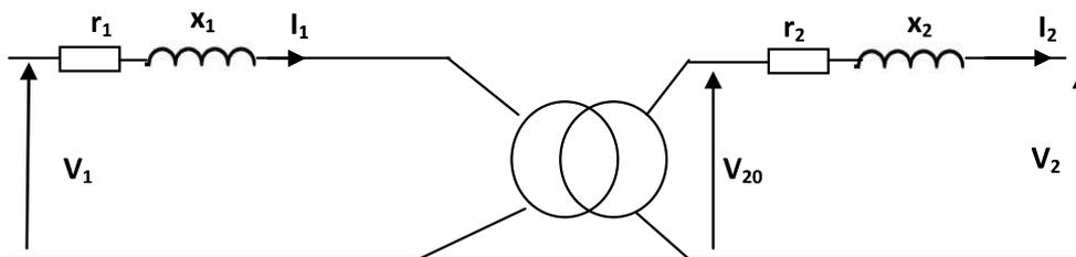
Fig. 2.11. Le schéma équivalent du transformateur (Kapp)
