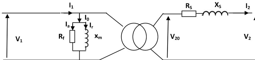
Fig 2.12 Schéma équivalent d'un transformateur ramené au secondaire
