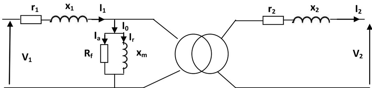
Fig 2.10. Le schéma équivalent du transformateur réel
