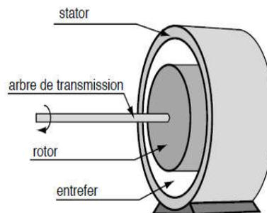
Fig.3.1 Constitution d'une machine à courant continu [1]
