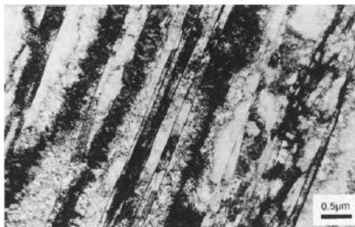
Figure 3.10 : Martensite en lattes de l'acier X12Cr13
