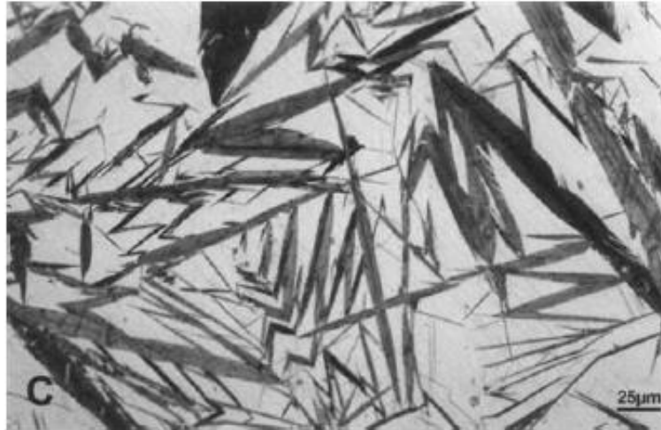
Figure 3.9 : Martensite en plaquettes de l'acier Fe-20Ni-0,5C
