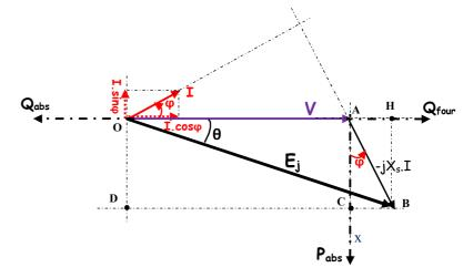
Maintenant, pour trouver la fem à vide (Ev), on doit calculer ses composantes (Evx et Evy). Avec :  $Ev = \sqrt{Ev_{\chi}^2 + Ev_{\gamma}^2}$
