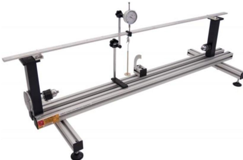
Figure 7 : Machine de flexion
