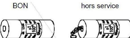
Fusible avec percuteur
