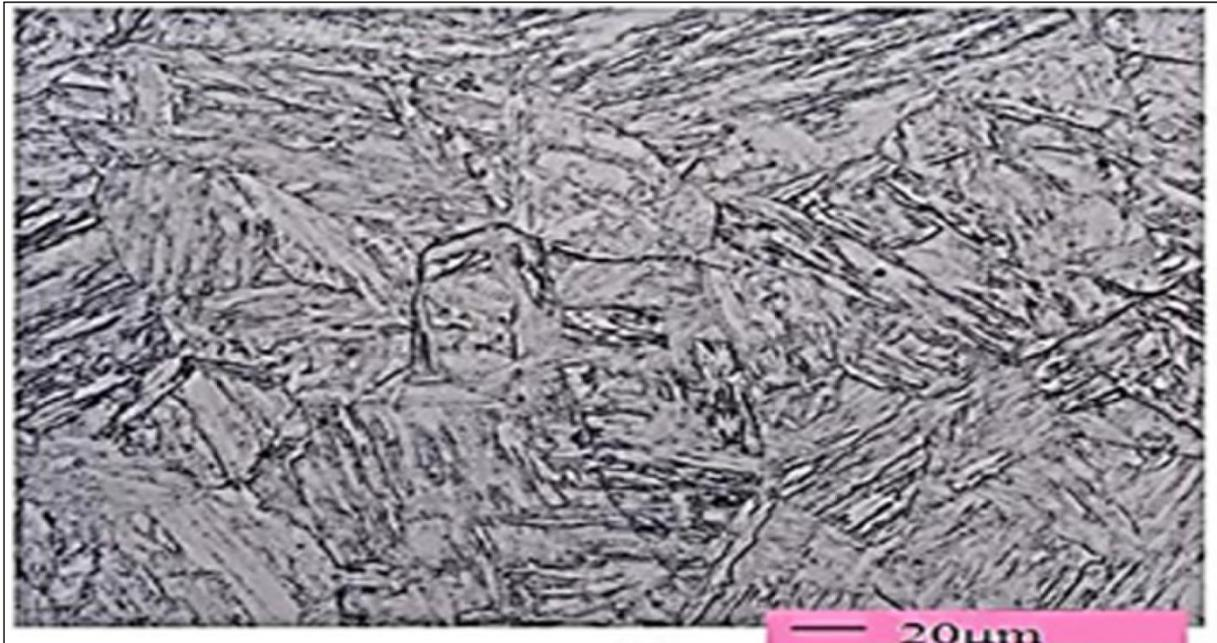
Figure 2-7 : Microstructure de l'acier inoxydable martensitique AISI 403 trempé dans l'huile à partir de 1040°C suivi par un revenu à 650°C [8].
