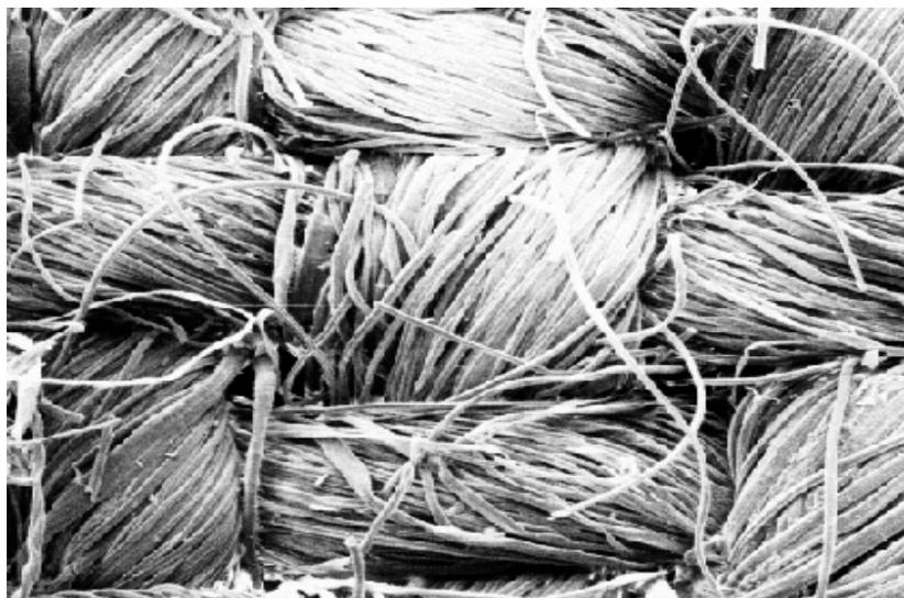
**Figure 9** : Dans une toile, les fils de coton entrecroisés sont faits de faisceaux de fibres
