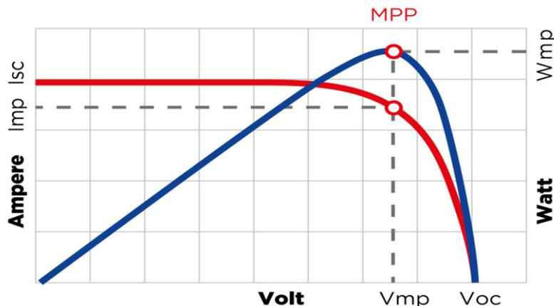
Figure 2.8 – Evolution du PPM d'un module photovoltaïque.
