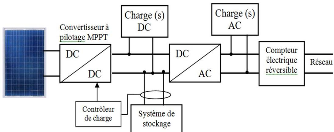
Figure 2.12 – Installation photovoltaïque couplée au réseau avec système de stockage.
