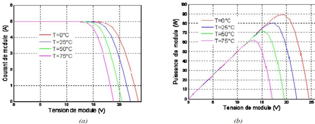
Figure 2.10 – Evolution de la caractéristique I(V) (a) et P(V) (b) pour différentes températures.
