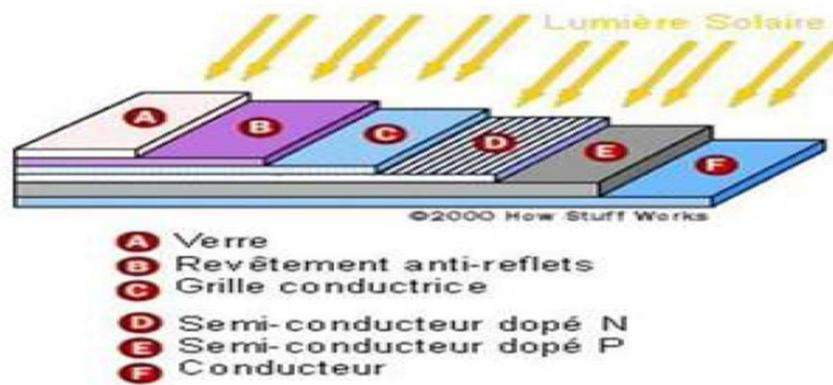
Figure 2.2 – Structure basique d’une cellule solaire.
