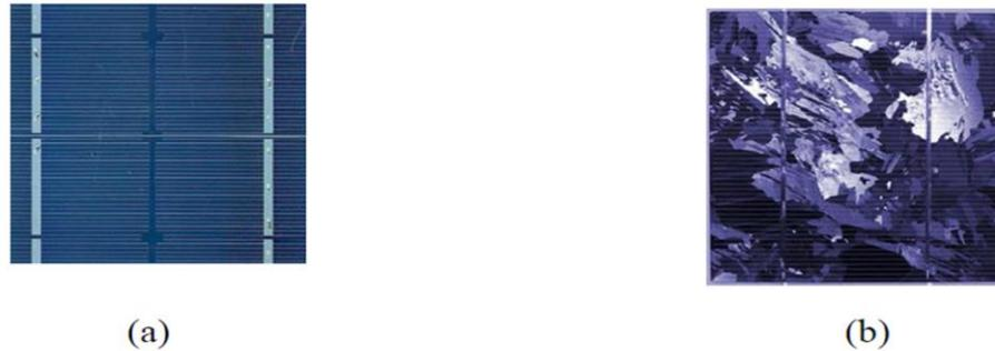
Figure 2.1 – Photos de cellules monocristalline (a) et multicristalline (b).
