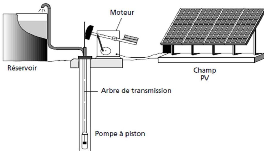
Figure 2.11 – Système de pompage photovoltaïque
