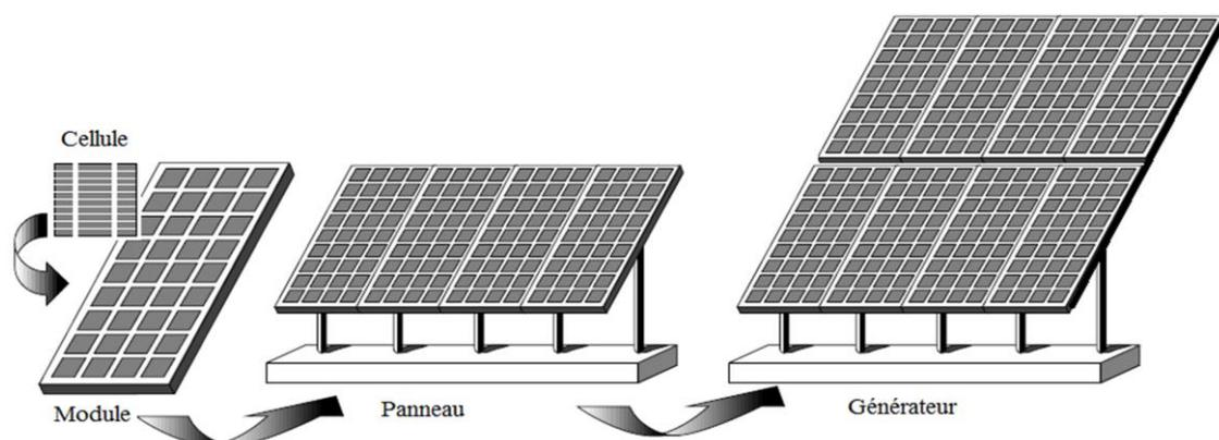
Figure 2.4 – Les principaux composants d’un système photovoltaïque.
