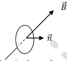
Le flux magnétique  $\varphi$  du champ magnétique B à travers une spire orientée de surface S est égal au produit scalaire des vecteurs B et S :
