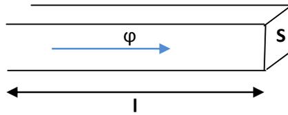
Fig.4.3. Portion d'un circuit magnétique
