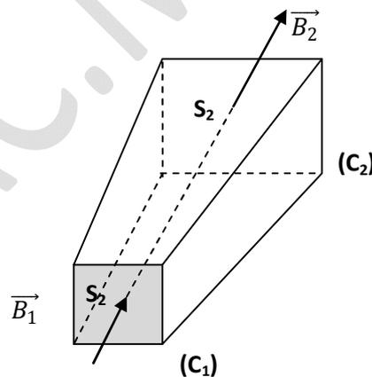
Deux sections  $S_1$  et  $S_2$  délimitées par les contours  $C_1$ ,  $C_2$  donc selon le principe de la conservation de flux on :  $\varphi_1 = \varphi_2$
