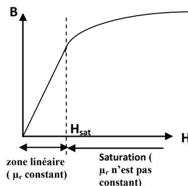
Dès que l'intensité H de l'excitation magnétique dépasse Hsat (intensité de saturation), l'induction magnétique B ne croît plus on dit que le matériau est saturé.
