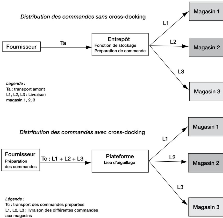
Figure 9.4 – Principe de fonctionnement du cross-docking
