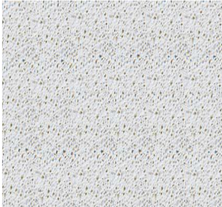
Figure 10: structure du béton cellulaire
