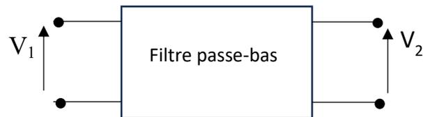
$H(\omega)$  est la fonction de transfert ou la réponse en fréquence du filtre :  $H(\omega) = \frac{V_2}{V_1} = |H(\omega)|e^{j\varphi}$ .
