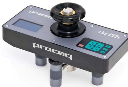
Cet essai peut toutefois être non destructif si l'application de la force minimale d'arrachement est arrêtée avant la rupture, mais il faut s'assurer qu'une résistance
