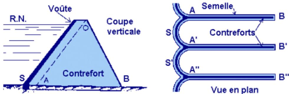
Les bouchures sont très souvent inclinées vers l'aval pour que la poussée de l'eau soit orientée vers le bas de façon à améliorer la stabilité des contreforts. Dans le sens transversal, notamment vis-à-vis des effets sismiques de rive à rive, les contreforts peuvent être munis de butons.
