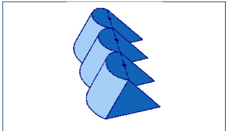
Ces barrages offrent un avantage considérable pour la quantité de béton nécessaire : il faut 4 à 5 fois moins de béton pour un barrage à contreforts par rapport à un barrage-poids de même hauteur. Inversement, il s'agit de structures complexes, plus sensibles aux effets thermiques et aux séismes et qui nécessitent une attention particulière pour le contact avec le rocher de fondation.
