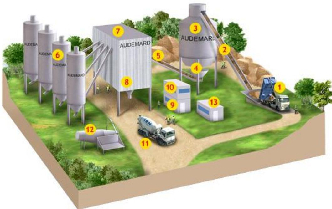
**1** :Les granulats sont livrés et déchargés par un semi-remorque dans la trémie de réception. Cette trémie est généralement couverte par un bardage qui limite le bruit et l'émission des poussières lors du déchargement. L'environnement est ainsi préservé de ces nuisances.
