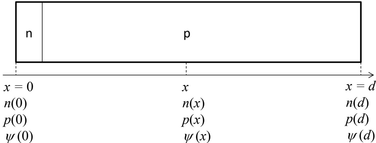
Les trois équations qui gouvernent le transport dans la jonction np (équations de Poisson et de continuité) doivent être vérifiées à chaque point du dispositif et la solution de ces équations implique la détermination ou le calcul des variables  $n(x)$ ,  $p(x)$  et  $\psi(x)$  à chaque point  $x$  ce qui définit complètement le système à chaque point  $x$  du dispositif.
