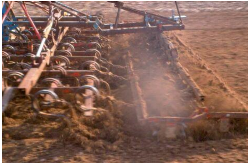
Association vibroculteur et rouleau pour la préparation du lit de semences
