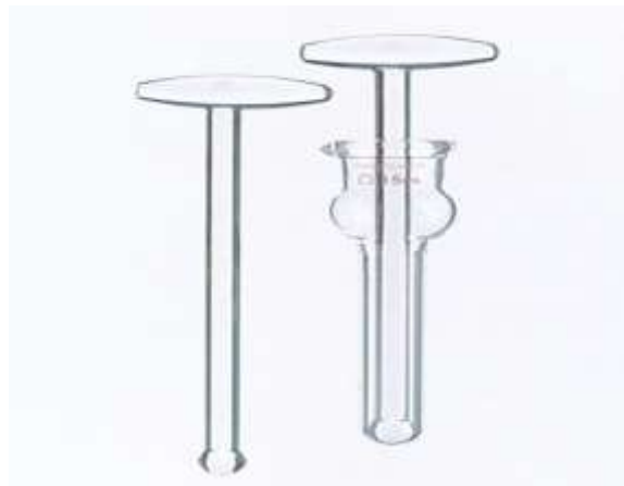
Figure : Broyeurs mécaniques en verre de type Dounce (Piston et cylindre).
