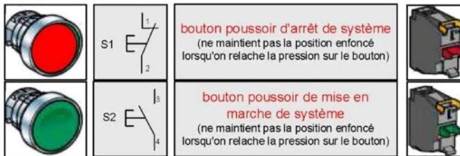
Figure I.2 : Etats des boutons poussoirs, S1 bouton poussoir initialement fermé, S2 bouton poussoir initialement ouvert.
